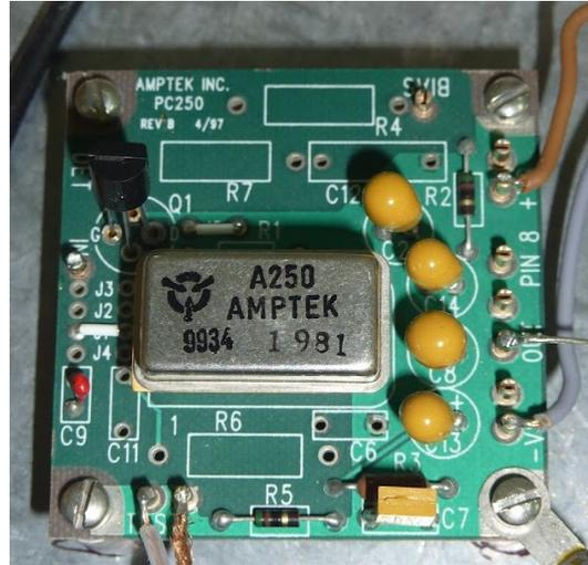
Figura 4.7: Circuito originale dell'A250; il FET è posto in prossimità dell'A250.
