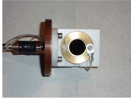
(b) Dettaglio: APD nel supporto di teflon.
