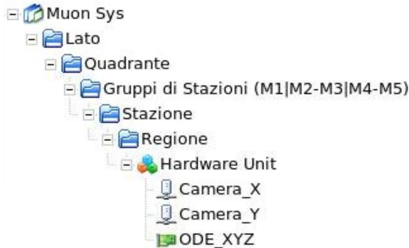
Figura 3.1: La struttura ad albero che rappresenta il rivelatore di muoni nella gerarchia FSM nell'ambiente PVSS
