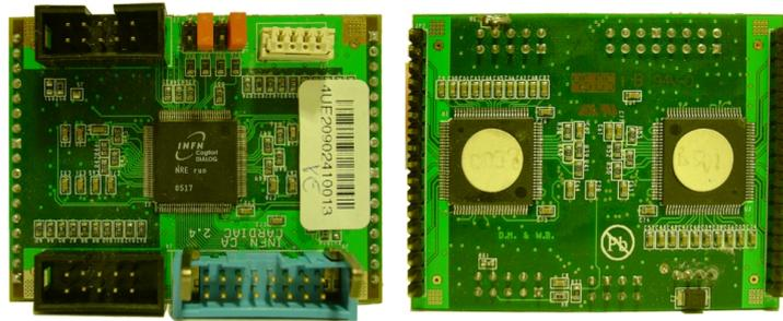
Figura 2.10: La scheda CARDIAC con i due chip CARIOCA e il DIALOG. I due connettori a pin dal lato dei CARIOCA ricevono i segnali dai due strati omologhi di camere, il connettore azzurro dal lato del DIALOG contiene i canali in uscita, i due connettori neri, identici, dallo stesso lato costituiscono l'ingresso e l'uscita della catena del bus I<sup>2</sup>C.
